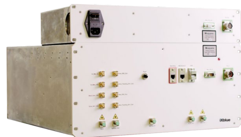
Station laser de régénération pour le transfert de référence de temps et fréquence
