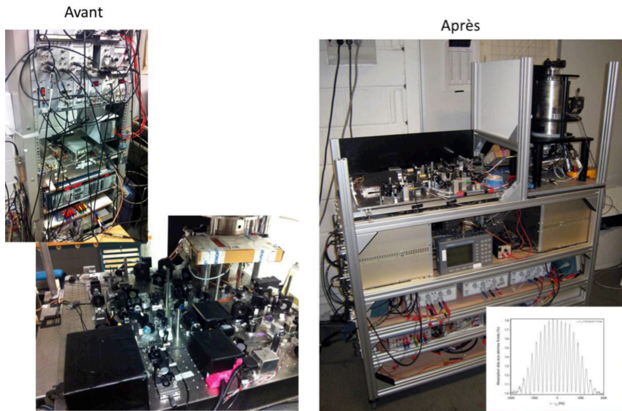
Fig 1 : Photos de gauche: version initiale d'Horace ; photos de droite : version actuelle d'Horace. Graphe en insert à droite : franges de Ramsey obtenues avec cette version actuelle.
